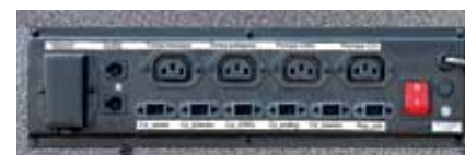
Гнездовой блок на боковой стенке котла
